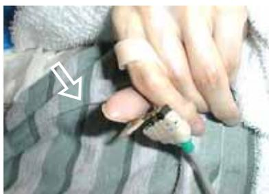
軽い作動圧で操作が可能なマイクロスイッチ（作動圧：8g）を熱可塑性素材に取り付けてスイッチとしました。
