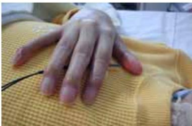
ファイバースイッチを人差し指に取り付け、親指のわずかな動きでも操作が可能のように調整することができます。
