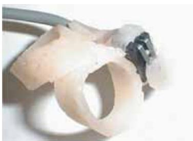
オムロン製マイクロスイッチを図にあるような指輪型スプリントに取り付け、親指を中心とした回旋の動きでスイッチを押しています。使用したマイクロスイッチの作動圧は、25gです。
