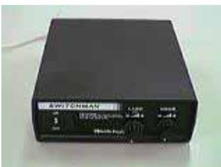
設定した時間(0~10秒)スイッチからの入力信号を保持することができます。接続を工夫することでナースコールの制御装置として利用できます。(P10 参照)
