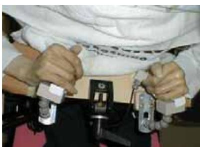
1個以上のスイッチが使える場合は、スイッチの組み合わせで、より操作性のよい車いす移動ができます。
