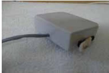
マイクロスイッチを右図のようにケースに入れて親指の動きで使えるようにしたものです。作動圧が軽いマイクロスイッチ (作動圧：8g) を使用しています。
