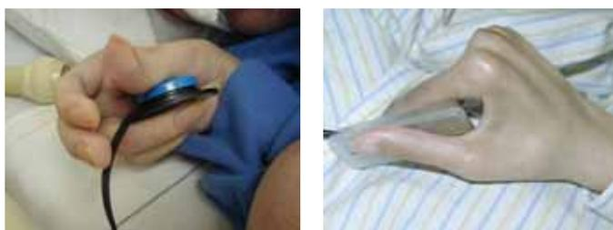
図 1 3 残存筋に合わせたスイッチの形
