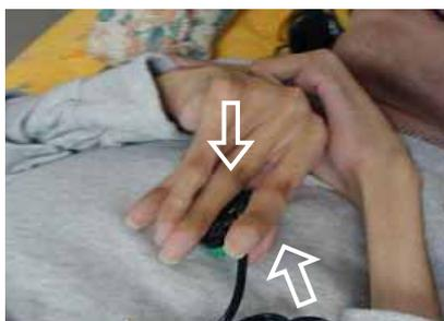
スペックスイッチは、薄い形状の押しボタンスイッチです。親指と2指から4指で、ちょうど、カスタンネットのような感じでスペックスイッチをはさむように設置します。
