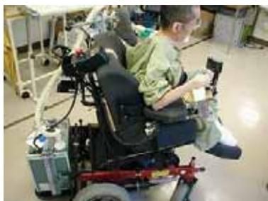
それでも前後左右に同じくスティックが傾斜出来ない場合は、車いす本体の制御装置の感度を調整することで改善します。
