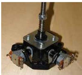
スティックが中立点に戻ろうとする力（バネの固さ）を軽くすると、少ない力で操作ができます。
